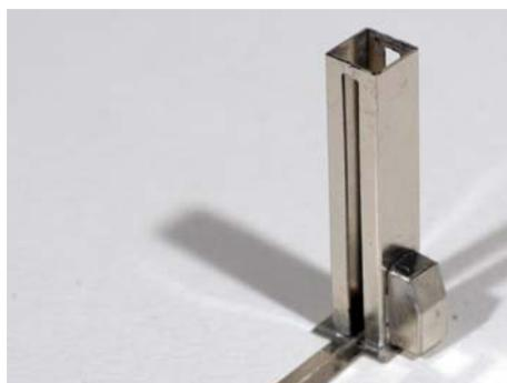
Souder les 2 demi poteaux bien perpendiculairement au rail de guidage. Mettre en place le moteur
