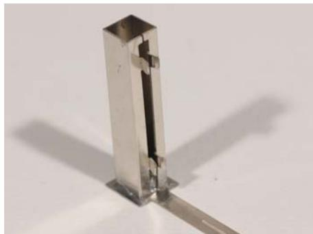
Souder le poteau bien perpendiculairement au rail de guidage.
