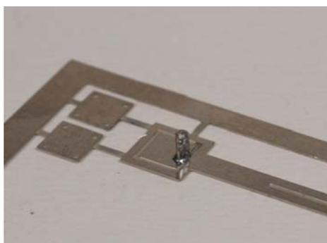
Mettre en forme la butée de poteau fermé et la souder en place avant de souder le poteau.
