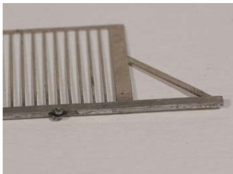
Utiliser une lisse basse du portail pour percer 5 trous de 0.6 mm et mettre en place des fil de 0.6 mm afin de centrer les différents éléments.
