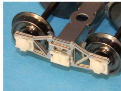
Dégrapper soigneusement les pièces en résine et les coller en place à l'aide de colle cyano.
