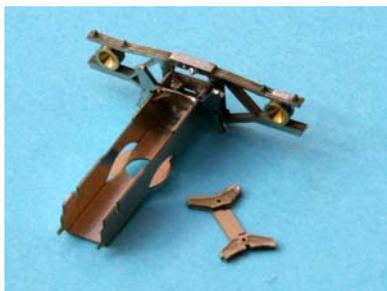
Mettre en forme les 2 ensembles de frein (6) et renforcer les mâchoires par une soudure par capillarité.
