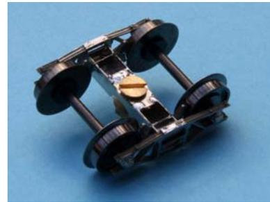
Mettre en place les essieux **côté isolé du même côté**, présenter le deuxième flanc de bogie et le souder en vérifiant sa perpendicularité.
