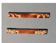
Circuit d'éclairage avant, utilisable sans modification de votre modèle : il suffit de rajouter des petits conduits fibre optique dans la cabine.
