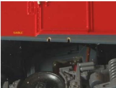
Agrandir les trous de 0.5 mm vers le bas de façon à réaliser 2 lumières.
