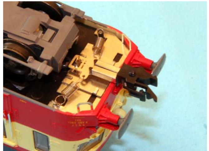
Monter les 2 ressorts de rappel et installer l'ensemble sous le châssis de votre autorail par collage.
