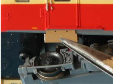
Utiliser le petit gabarit pour percer 2 trous de diamètre 0.5 mm sous les portes coulissantes des extrémités de l'autorail.
