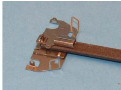
Caler le timon à environ 1.5 à 2 mm à l'aide d'un objet (ici une lime). Souder en ayant vérifié la cote de dépassement souhaitée.
